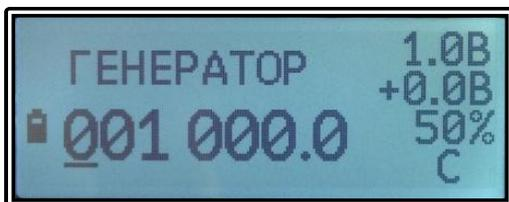
Время самовыключения прибора в 4 раза больше, чем по умолчанию. Необходим внешний разделительный конденсатор для подачи сигнала в схему под напряжением. Подключается к щупу, расположенному ближе к боковому переключателю. Другой щуп - общий. В этом режиме прибор не выключается "экраном вниз" и не работает функция автоматического изменения отображения на экране при работе правой или левой рукой.
