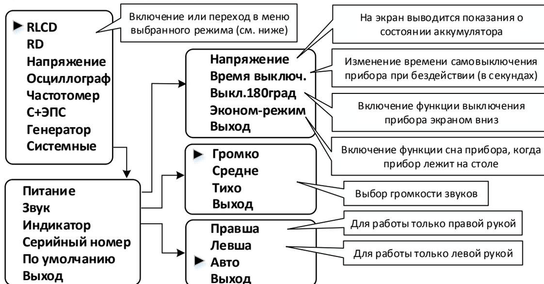
Выбор нужного режима - кратковременное нажатие на соответствующий пункт меню. Если при выборе режима работы (**RLCD**, **RD**, **Напряжение** и т. д.) удерживать регулятор до второго пика пицалки, то выбранный режим сохраняется в энергонезависимой памяти. При следующем старте прибор включится в этом режиме.
